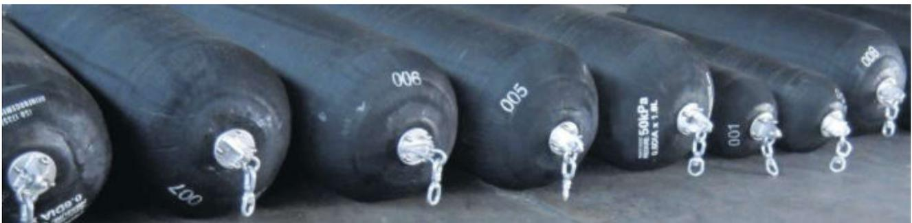
I nostri **fender pneumatici** in gomma sono composti da uno strato di gomma rinforzata con corde sintetiche e gonfiati ad aria compressa, per consentirgli di galleggiare sull'acqua.
