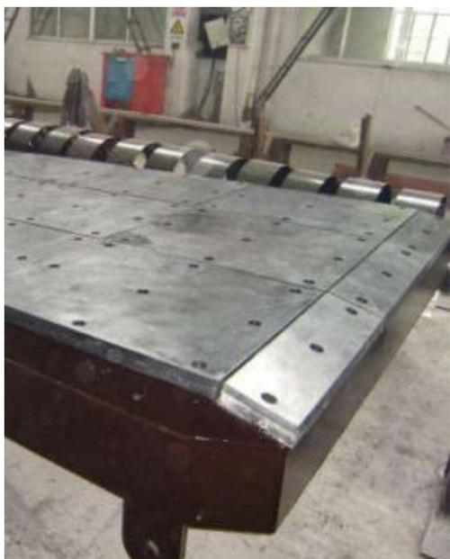
Questi pannelli in acciaio sono montati sulla testa dei fender a cellula, conici, e "Unit Element", e sono utilizzati per distribuire le forze di reazione dall'elemento di gomma allo scafo della nave.
